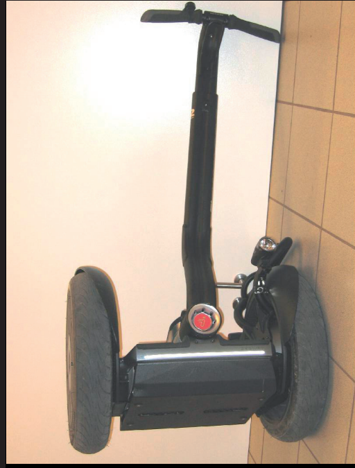
SEGWAY auf die linke Seite legen Turn your SEGWAY down on the left side
